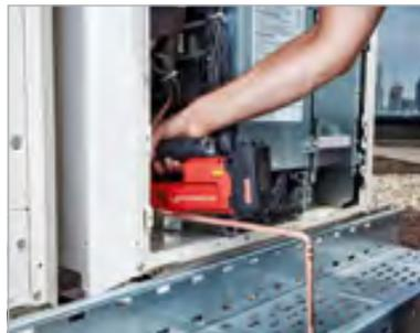
Avantage de la structure à deux cylindres : La machine peut être utilisée d'une seule main.
