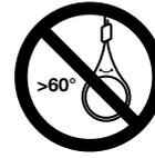
L'angle final formé par la boucle ne doit en aucun cas excéder 60°, sous peine d'endommager le galet.
