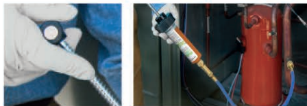
Injection du colorant en tournant la poignée.
